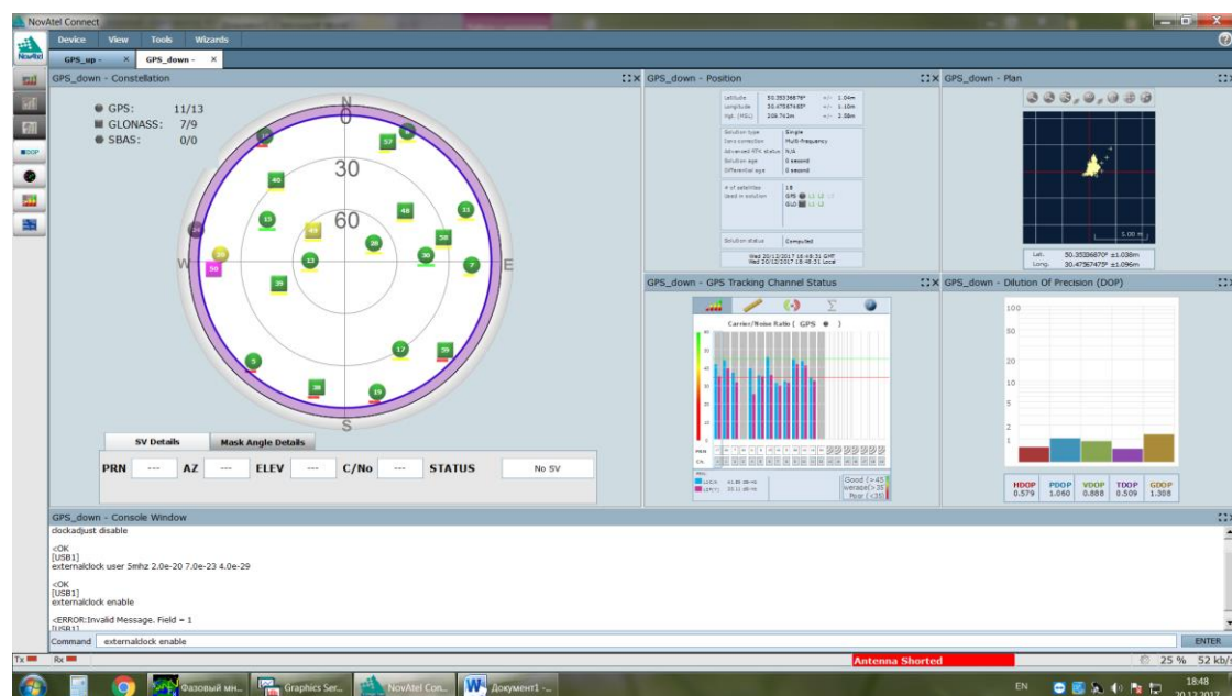
Рисунок 4. Сузір'я навігаційних супутників, сигнали яких формують сигнал для ПТК «Гравіки»
